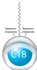
Сбалансированная фаза C18, обеспечивающая максимальную степень гидрофобной селективности по сравнению с другими фазами Kinetex
