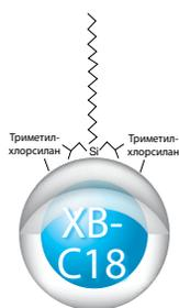
Данная уникальная фаза C18 обеспечивает более эффективное водородное связывание при гидрофобной селективности, что приводит к улучшению формы пиков для основных соединений и увеличению времени удерживания кислотных соединений
