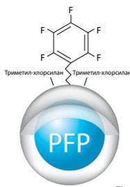
Пентафторфениловая фаза обеспечивает высокий уровень стерического взаимодействия для улучшения разделения структурных изомеров, а электроотрицательные фторсодержащие группы обеспечивают улучшенное удержание полярных основных соединений
