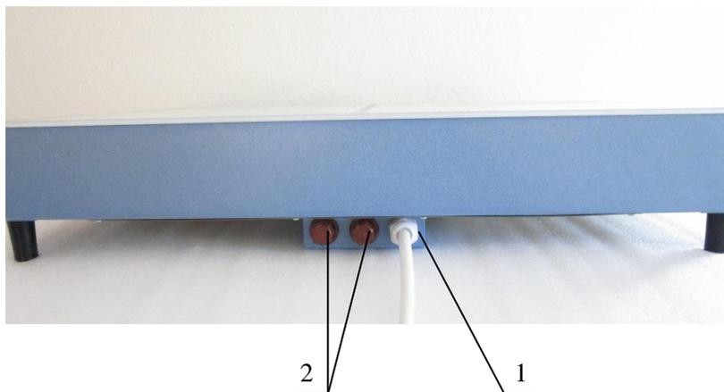
1 - кабельный ввод с выводом сетевого кабеля;
