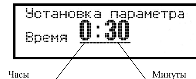
Рисунок 6 – Вид дисплея в состоянии задания времени нагрева
