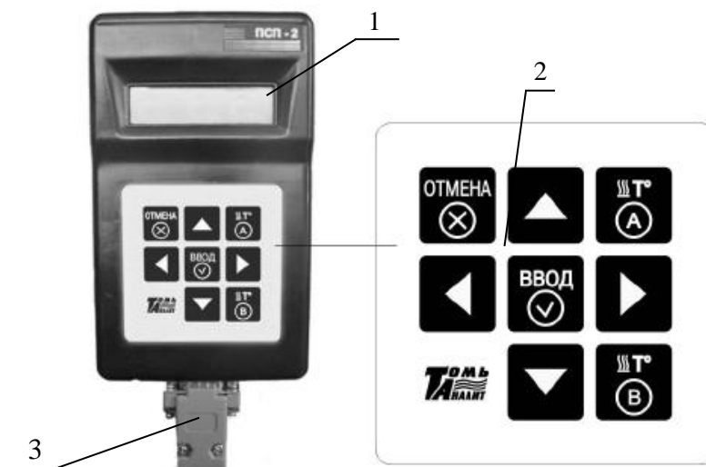
1 – цифровое табло; 2 – панель с управляющими кнопками; 3 – разъем для подключения кабеля
