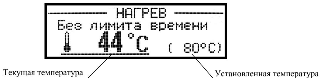
Рисунок 8 – Вид дисплея в состоянии нагрева без контроля времени
