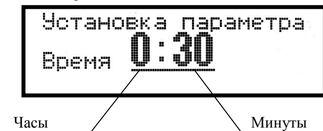
Рисунок 6 – Вид дисплея в состоянии задания времени нагрева
