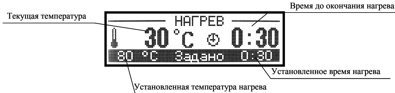
Рисунок 7 – Вид дисплея в состоянии нагрева в течение установленного времени
